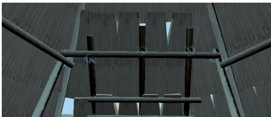
Joonis 20. Katuse sektsioon. Palkidevahelised ühendused (PinJoint) tähistatud helesinises.
