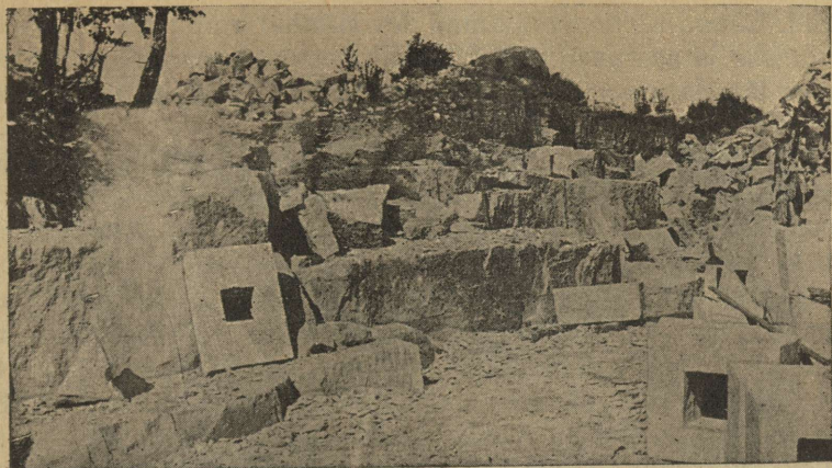
39. joonis. Saaremaa Kaarma dolomiidi murd Kuingul. Tähele panna pakse kihte! Esiplaanil valmistatud korstnakive.
