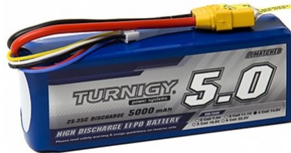
Joonis 3: Teises generatsioonis kasutusel olev 4S LiPo aku [25]
