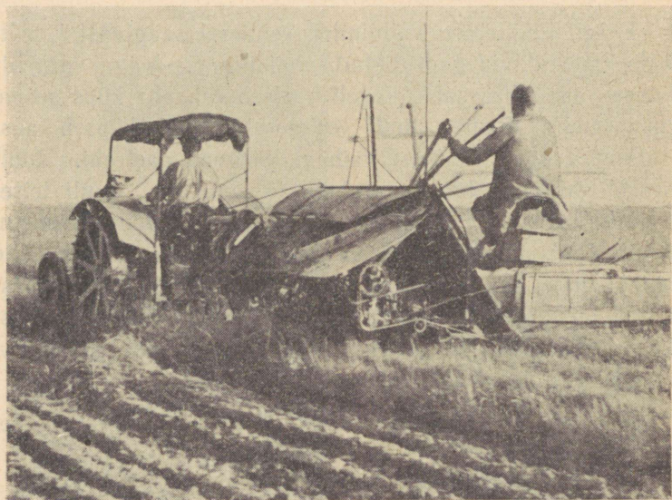
Joon. 40. Keraheina seemnepõllu koristamine traktorijõul töötava isesidujaga.
