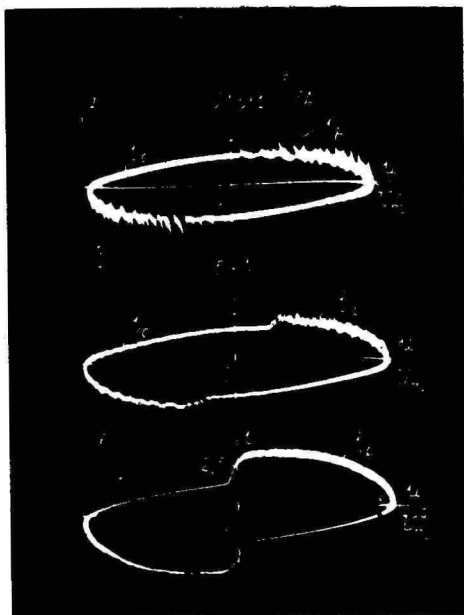
Рис. 1. Вольтамперные характеристики разряда в узкой газовой полости, ограниченной пленками полиэтилена: момент включения (а), через полчаса (б) и через два часа (в) после включения напряжения (50 Гц); i_c - емкостной ток и i_p - токи разряда.
