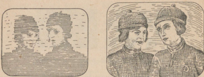
Joon. 10. Kuidas mõjub kujutise kvaliteedile laotusridade arv (vasakul — 30 rida, paremal — 120 rida).
