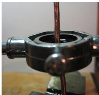
Joonis 35. Vitsatraadi keermestamine.
