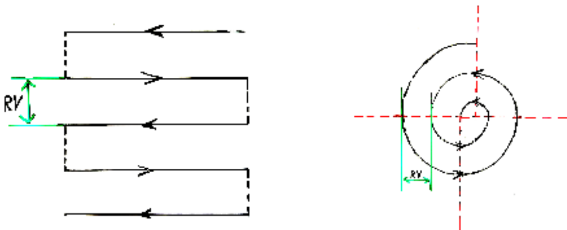
Joonis 4.7. Pihustumuster sirgete paralleelsete radadega(a) ja pseudospiiraaliga(b);
