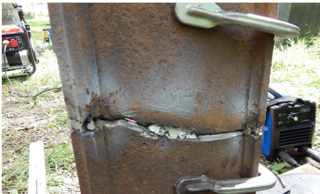
Joonis 8. Servadest ja esipinna keskelt keevitatud lõigud (autori foto).
