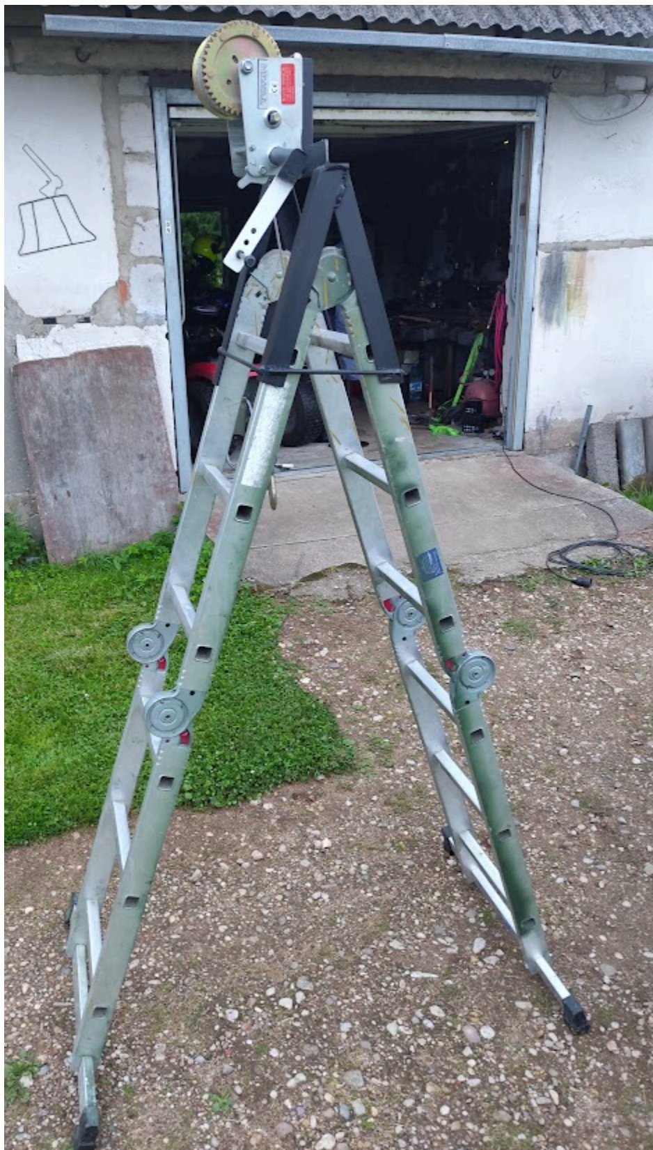
Joonis 5. Haaradega risti osa tõstmiseks valmistatud vintsi rakis (autori foto).
