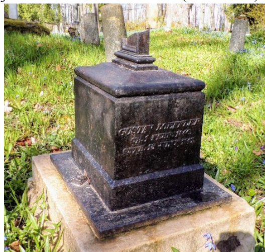
Joonis 18. 10 kuud inhibiitoriga kaetud ja värvimata malmristi alus (autori foto)
