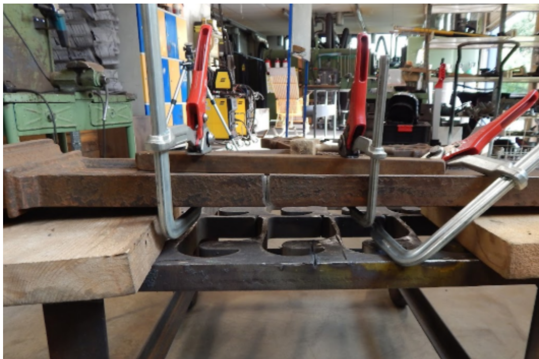
Joonis 11. Keevitamiseks ettevalmistatud ja fikseeritud malmist töölaual (autori foto).
