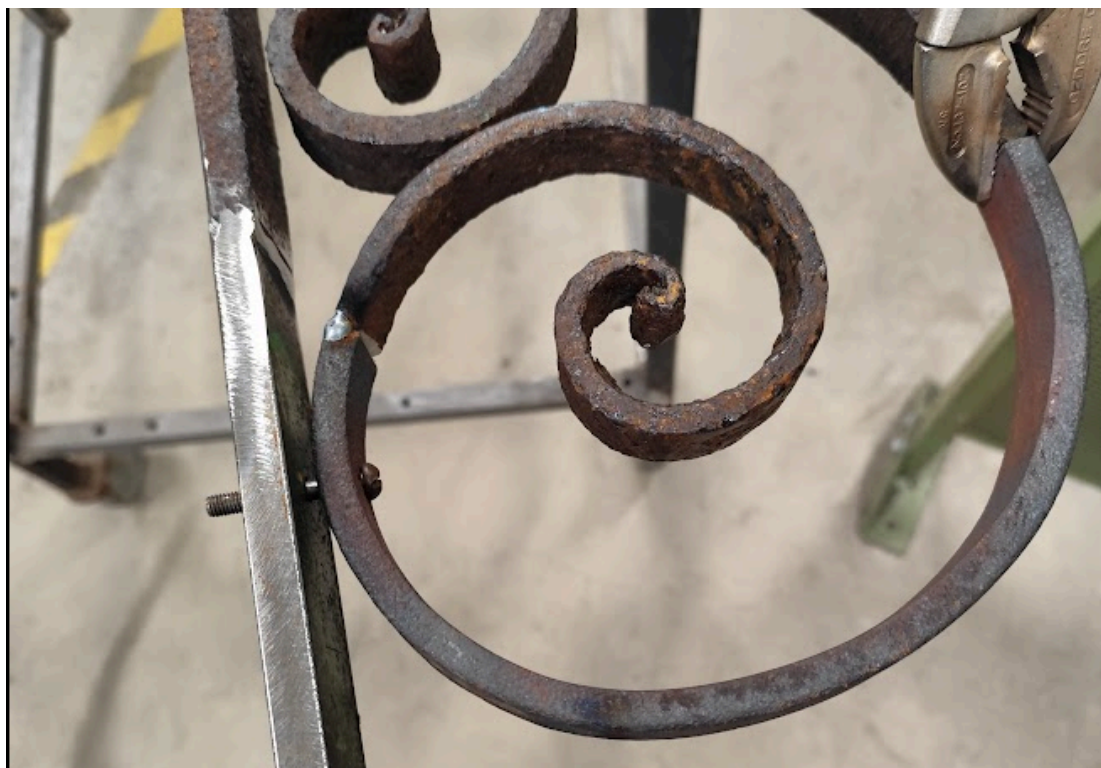
Joonis 27. Voluudi asendusdetaili koostamine (autori foto).
