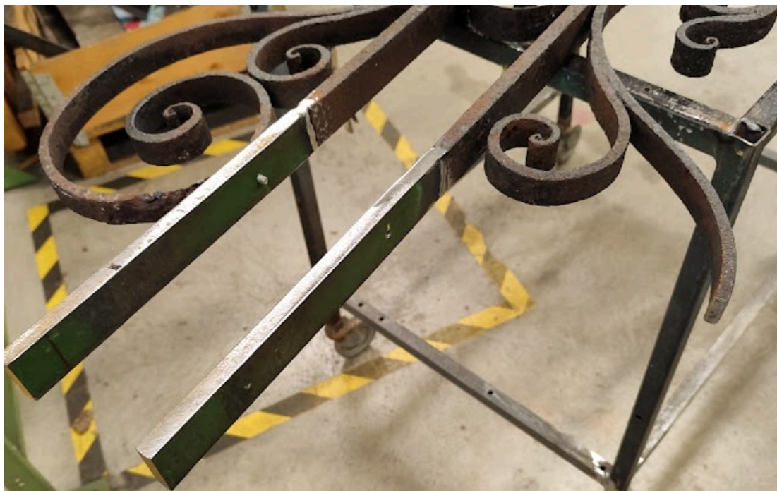
Joonis 26. Vertikaalraami asendusdetailid külge kevitatud (autori foto).
