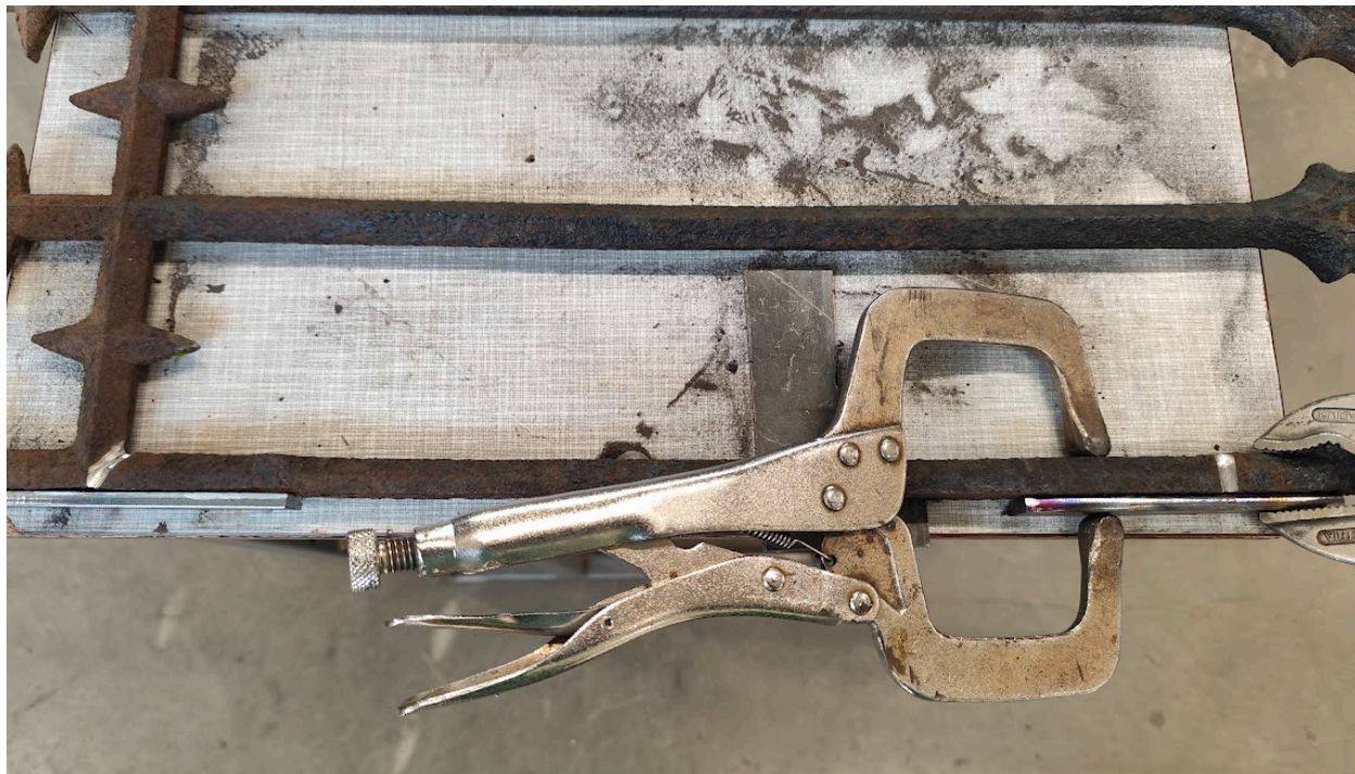
Joonis 17. Kevitamiseks ettevalmistatud, fikseeritud ja faasitud kinnituslatt (autori foto).
