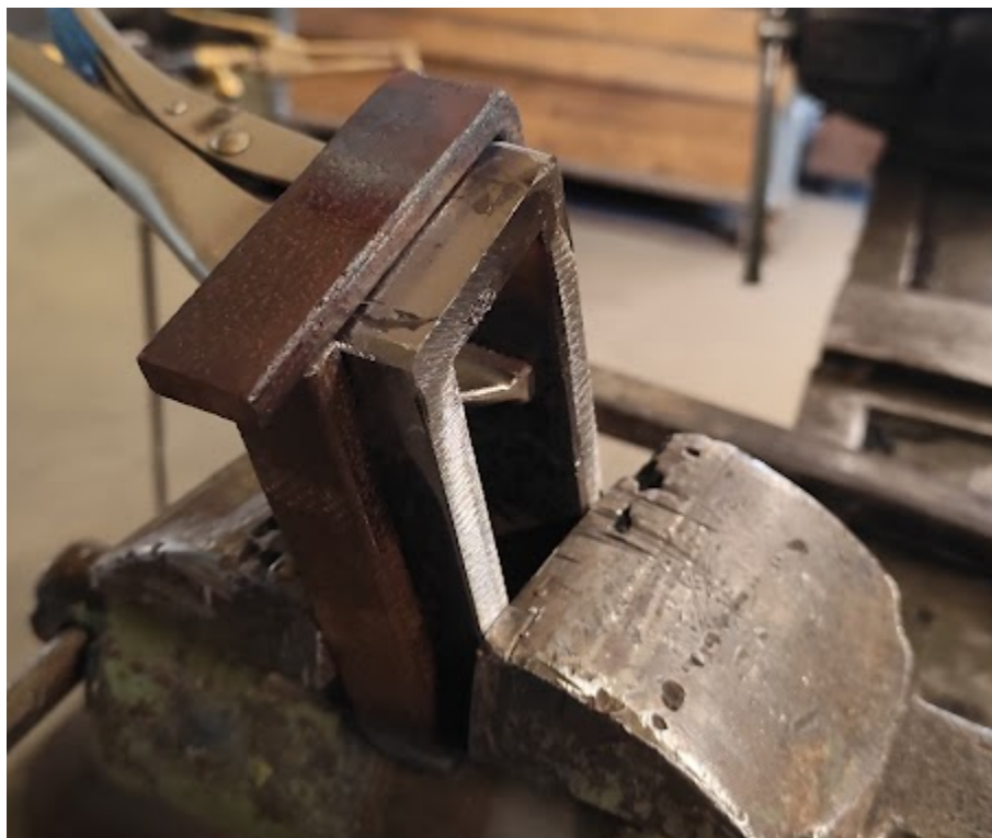
Joonis 24. Kahekihilise kinnitusklambri valmistamine
