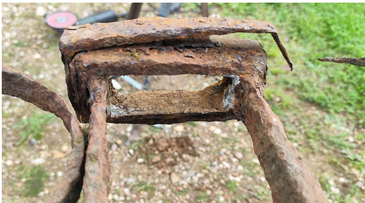
Joonis 23. Puhastatud algne kinnitusklamber (autori foto).
