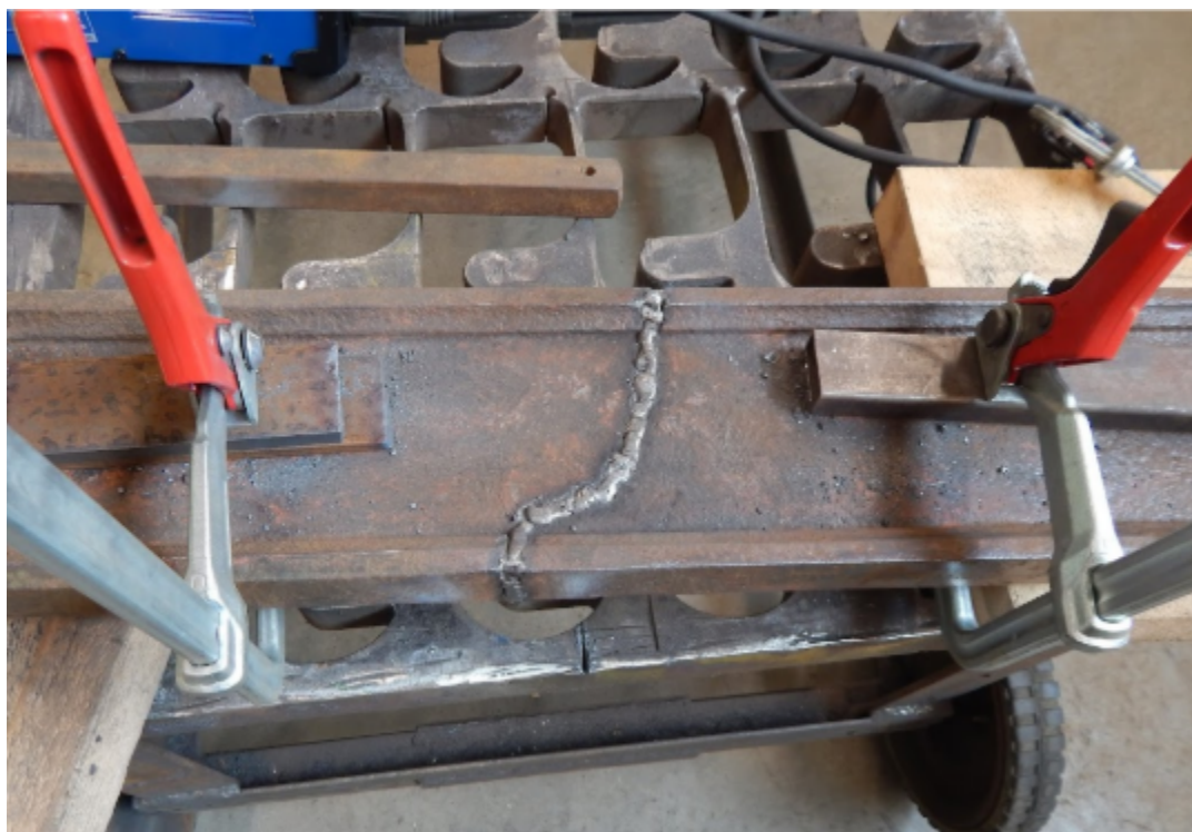
Joonis 14. Jala ja keskmise osa keevisõmblus enne järeltöötlust (autori foto).
