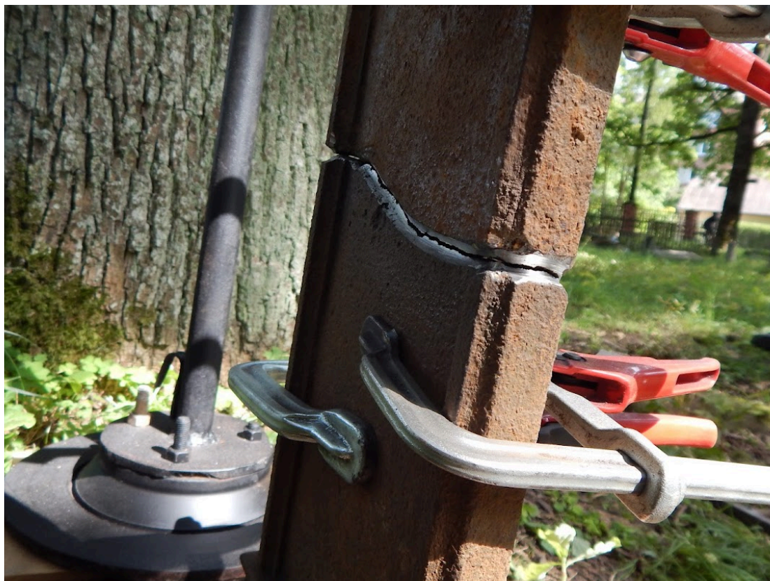
Joonis 7. U- kujuline faas keevitataval murdepinnal (autori foto).
