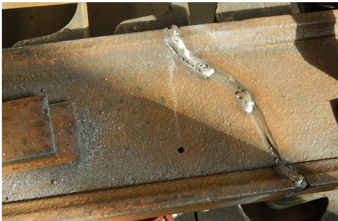
Joonis 14. Jala ja keskmise osa keevisõmblus enne järeltöötlust (autori foto).
