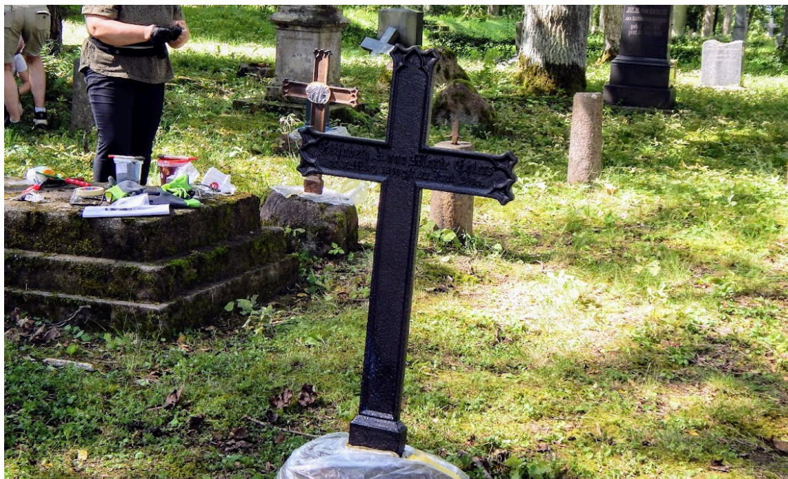
Joonis 3. Malmrist peale inhibiitoriga katmist (autori foto).
