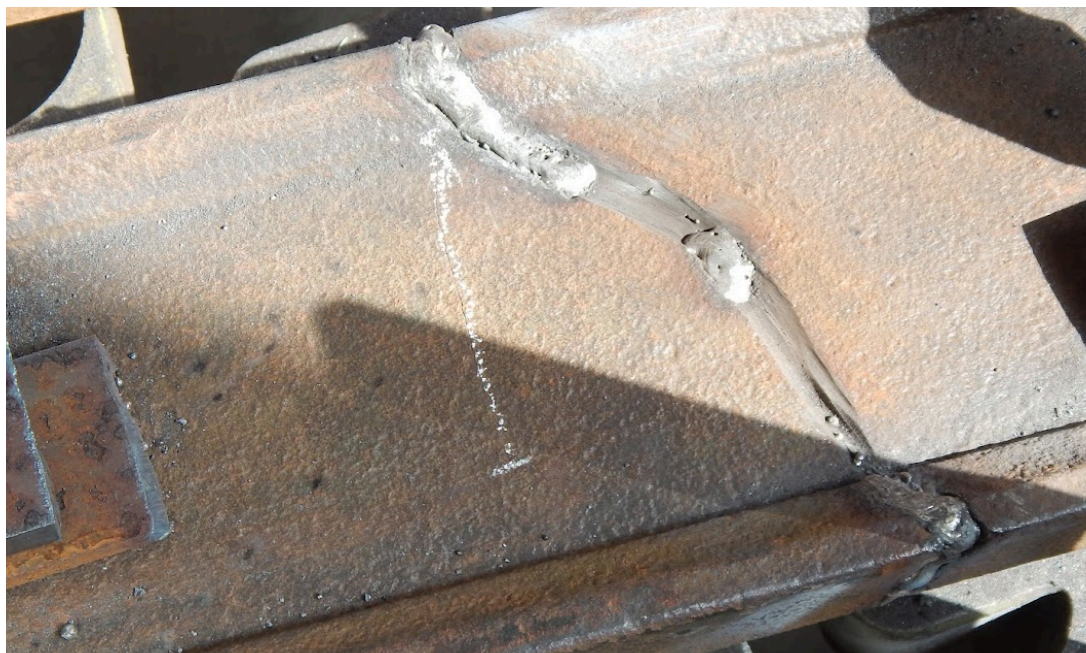
Joonis 12. Haarade keevitamisel jala külge nähtavale tulnud pragu (autori foto).
