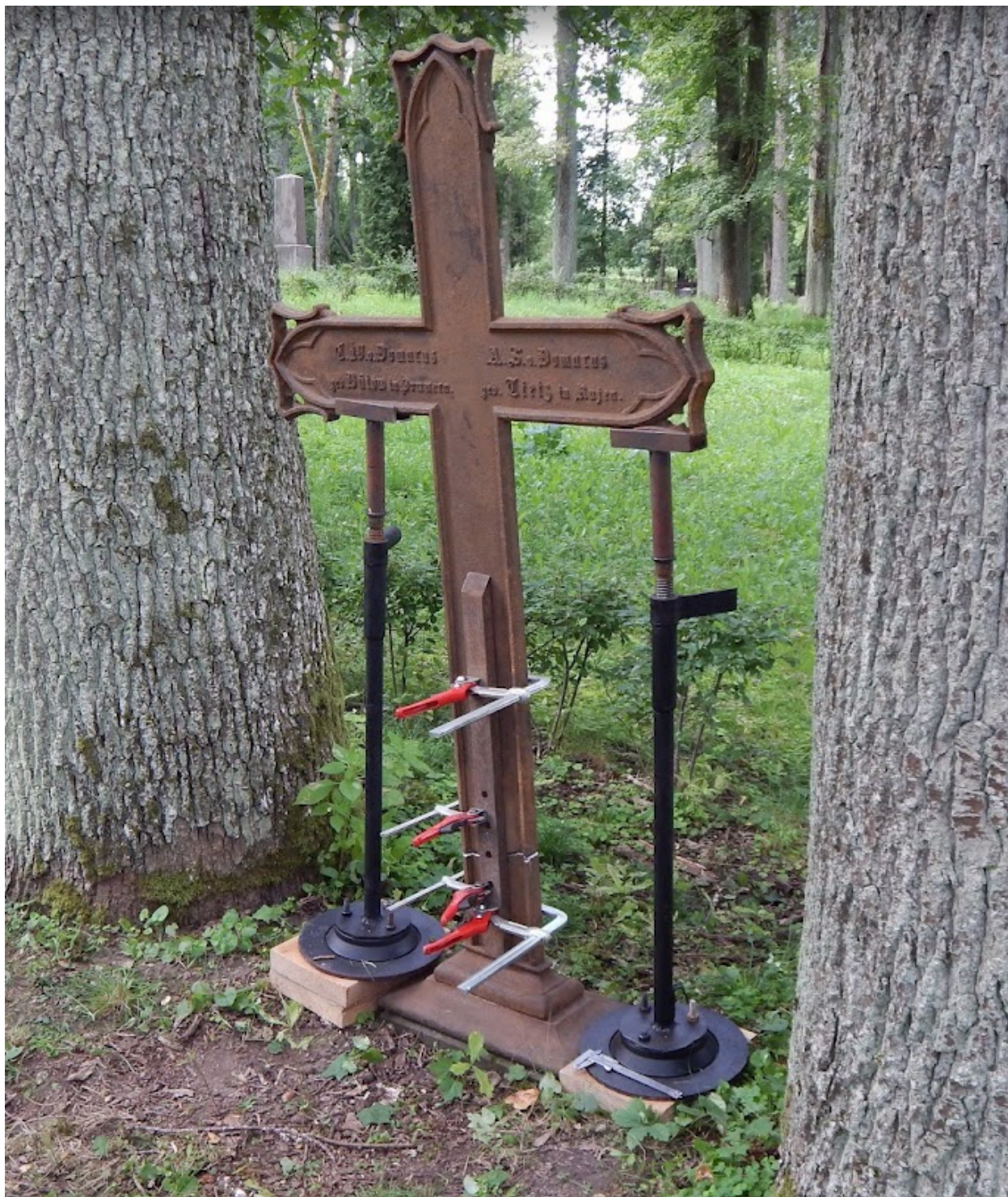
Joonis 6. Rakisele paigaldatud ja fikseeritud rist enne keevitustööde algust (autori foto).
