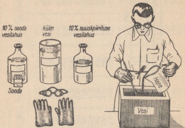
Joon. 4. Elektrolüüdi valmistamine. Kaitseabinõud happega töötamisel.
