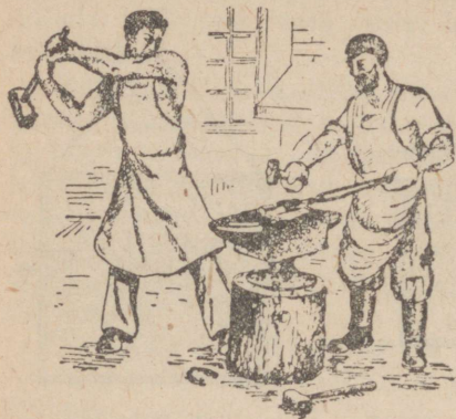
Joon. 346. Sepistamine käsivasaraga. Sepp näitab pealelööjale väikese vasara abil koha, kuhu ta peab lööma.
