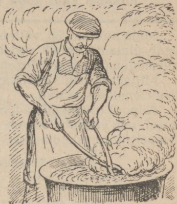
Joon. 349. Kuumutatud eset kastetakse vette või õlisse. Ese karastub.
