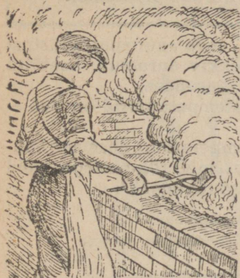
Joon. 348. Et eset karastada, tuleb ta esmalt tugevasti kuumutada.
