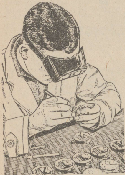
Joon. 551. Kellamehhanismide kokkupanemisel kasutatakse sageli luupe.
