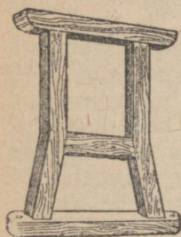
Joon. 342. Puidust valmistatud masinajalase mudel.
