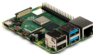
Figure 4. Raspberry Pi 4B+. Michael H. („Laserlicht“), CC BY-SA 4.0, via Wikimedia Commons.
