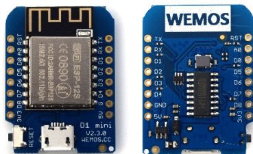
Figure 3. Wemos D1 mini (ESP8266) [22].
