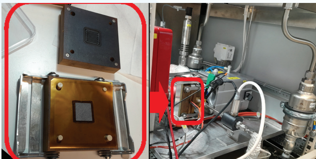
HT-PEMFC ühikrakk, mille jaoks katalüsaatoreid valmistati ja ühikrakk töötavas HT-PEMFC seadmes (autor: Marek Mooste).
