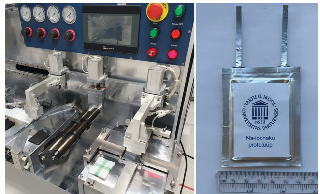
Akupatarei elektrodide ja separaatori kokkupakkimise seade ning valminud Na-ioonaku prototüüp. Foto: Maarja Paalo.
