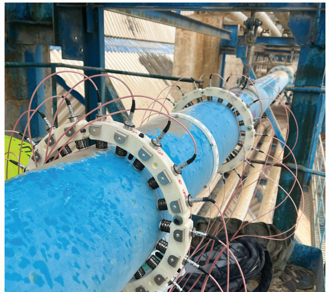
Torude kontroll ultrahelitomograafiaga. Foto: Marek Rist.
