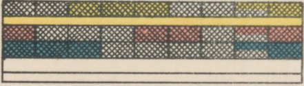
6. Film pärast valges valguses valgustamist ja värvilist ilmutamist lahuses purpursel komponendiga (purpursel komponentpositiivi moodustumine)
