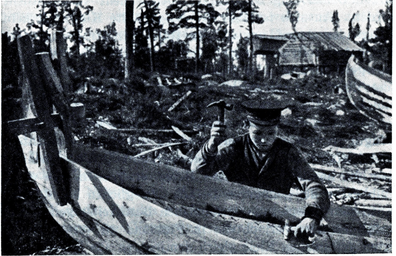
Abb. 7. Ein Lappe beim Nähen eines Bootes. Nach H a l l s t r ö m (Fataburen 1909).
