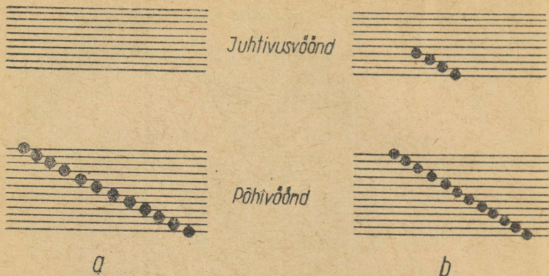
Joon. 3—2. Energiavööndid juhis ja mittejuhis: a — mittejuht; b — elektrijuht.
