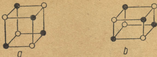
Joon. 2—9. Kloor- ja naatriumioonide asetus keedusoolakristallis (kloorioon — must kera, naatriumioon — valge kera). a — kristalli normaalne kuju; b — kristall pärast kokkusurumist.
