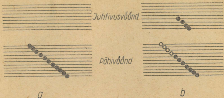
Joon. 3—3. Energiavööndid pooljuhis. a — pooljuhi temperatuur on madal; b — pooljuhi temperatuur on kõrge.
