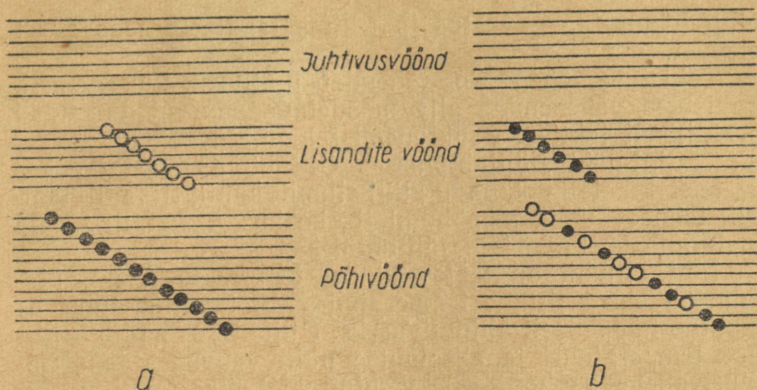
Joon. 3—5. Aktseptori mõju pooljuhi energiavöönditele. a — pooljuhi temperatuur on madal; b — pooljuhi temperatuur on kõrge.
