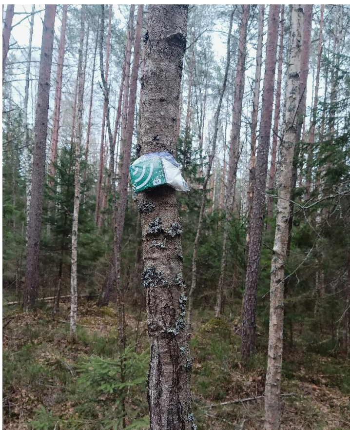
Joonis 2. Helisalvesti Audiomoth paigaldati umbes 1,5 meetri kõrgusele, ilmastikukindluse tagamiseks olid helisalvestid niiskust imava silikageelikotikesega sulguriga kilekotis. Autori foto.
