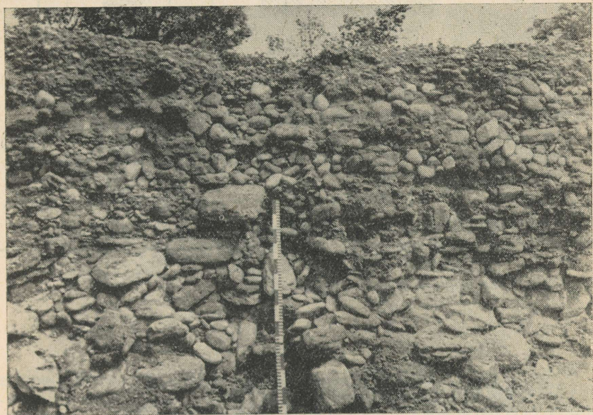
Рис. 21. Морской гравий с горизонтальной слоистостью, встречающийся близ Таллина; используется для мощения дорог и для изготовления бетона.
