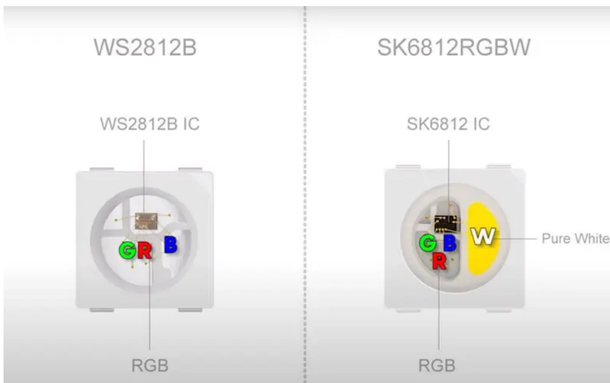
Joonis 2.1: WS2812B ja SK6812RGBW valgustid [1]
