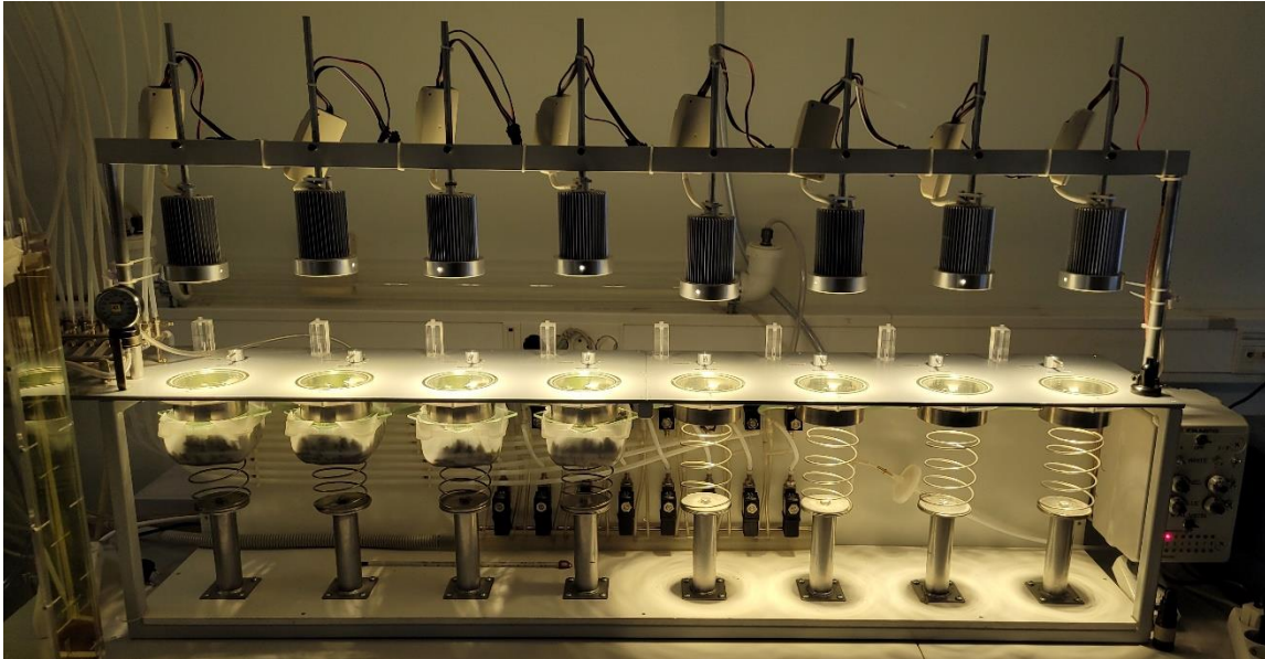
Joonis 2. Kaheksa-kambriline aparatuur hariliku müürlooga roseti gaasivahetuse mõõtmiseks. Pildistanud Benelote Uusküla.
