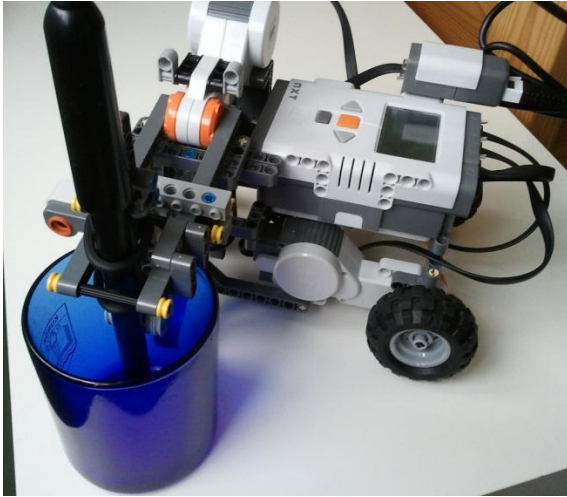
Joonis 22. Ülesande 4 lahendamiseks sobilik robot soolsuse mõõtmise asendis.
