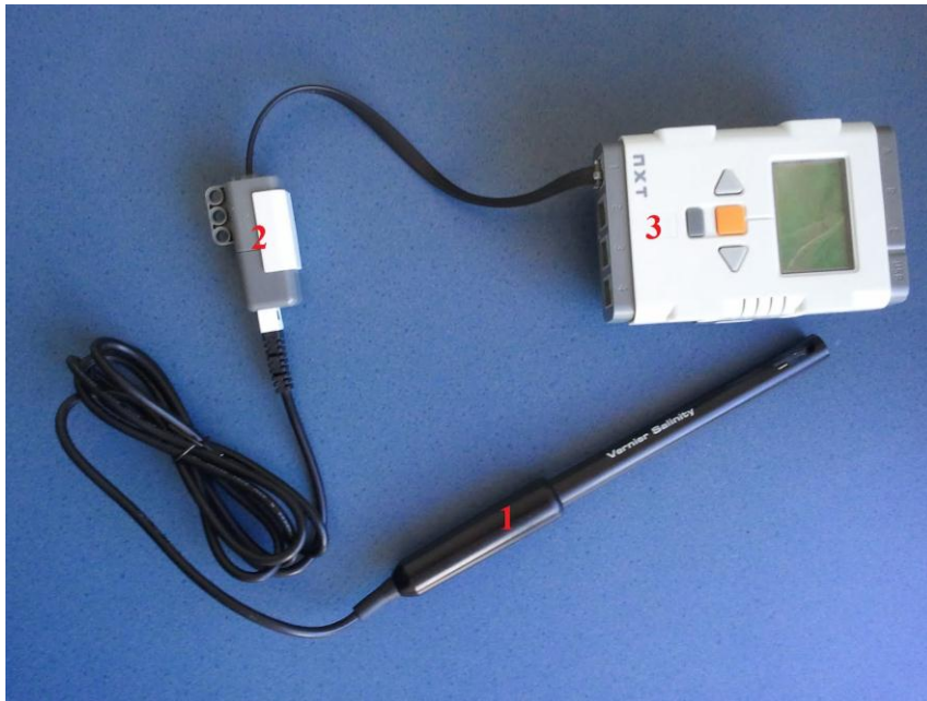
Joonis 10. Soolsuse anduri (1), NXT adapteri (2) ja LEGO NXT juhtploki (3) ühendamine.
