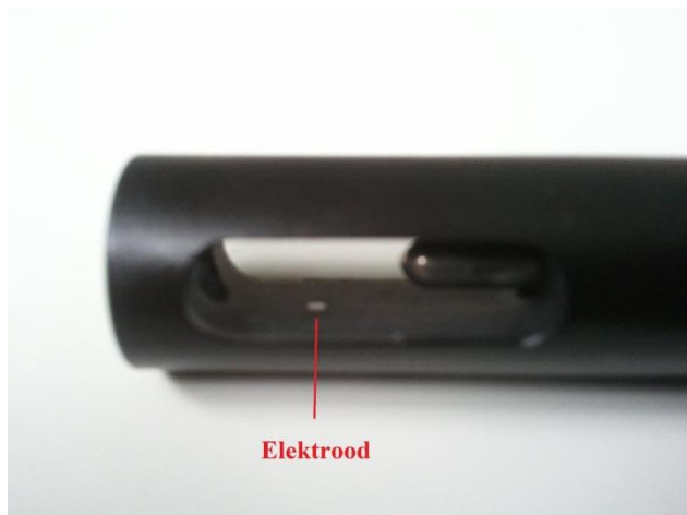
Joonis 8. Soolsuse anduri otsas asuv elektrood.
