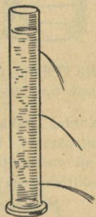
48. joonis. Vee rõhumine seinale oleneb kohta sügavusest.
