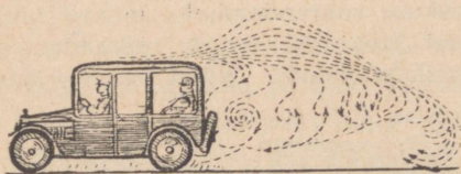
21. joonis. Auto liikumisel tekkinud õhukeerised takistavad liikumist.
