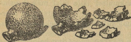
Joon. 65. Jääks muutudes paisub vesi tugevasti ja lõhub raudpommi.
