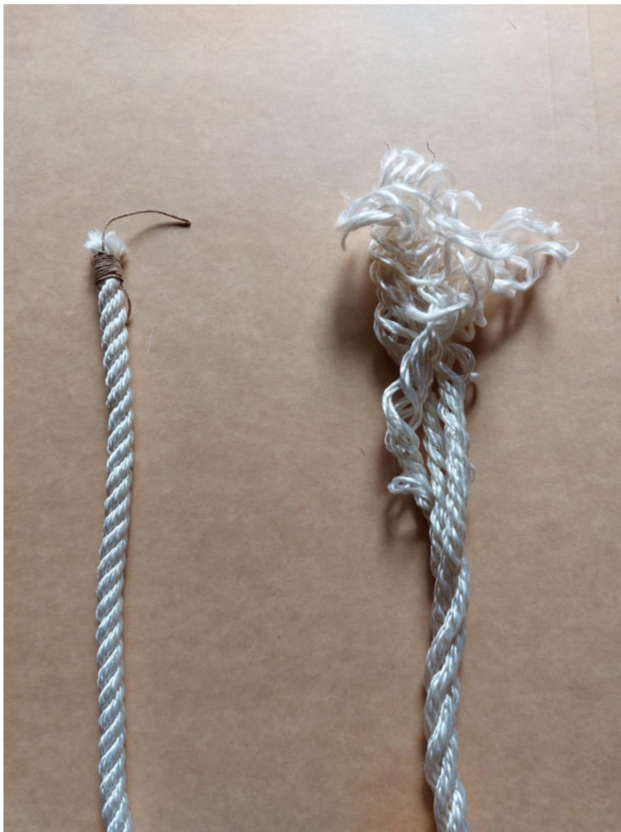
Joonis 65. Markide olulisus köie järkamisel (M. Kalm)
