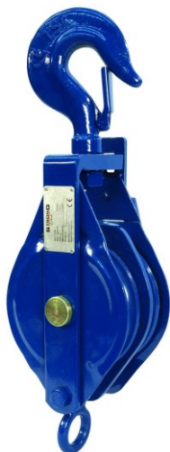
Joonis 17. Kahekordse läbivusega plokiratas. Maksimaalne lubatud töövõime 500 kg/4,9 kN, kuni 8 mm köis/tross (Tööriistamarket, 2025)
