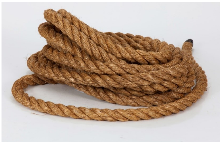
Joonis 10. Manilla köis (Manila Rope, 2014)
