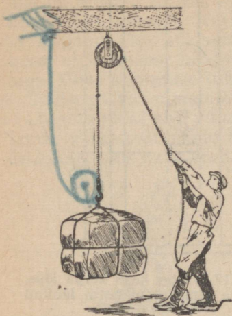
Joon. 118. Ühe liikuva ja ühe liikumatu ploki süsteem.
