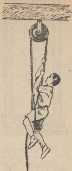
Joon. 119. Üle liikumatu ploki on pandud nõör, mille ühes otsas on silmus, kuhu on asetatud võimleja jalg, teist otsa tõmbab võimleja, tõstes iseennast.
