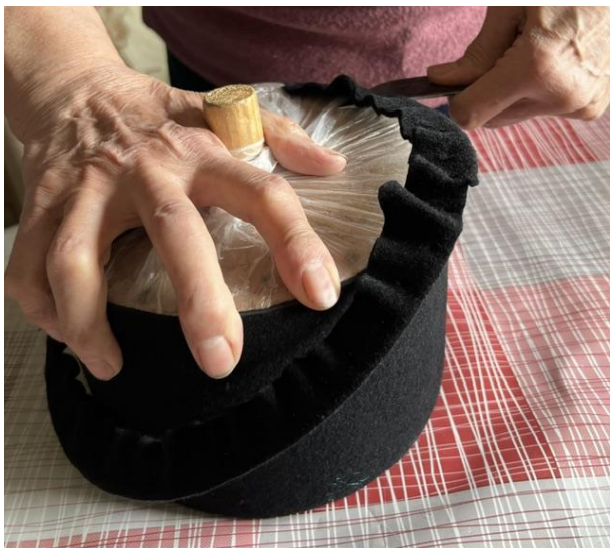
Joonis 9. Serva lõikamine vormi servaga tasa.
