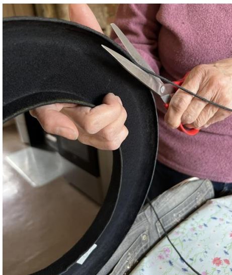
Joonis 11. Kübara serva tasandamine kandi paigaldamiseks
