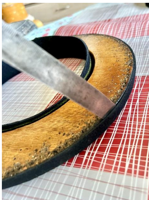
Joonis 10. Servaosa vormist eemaldamine
