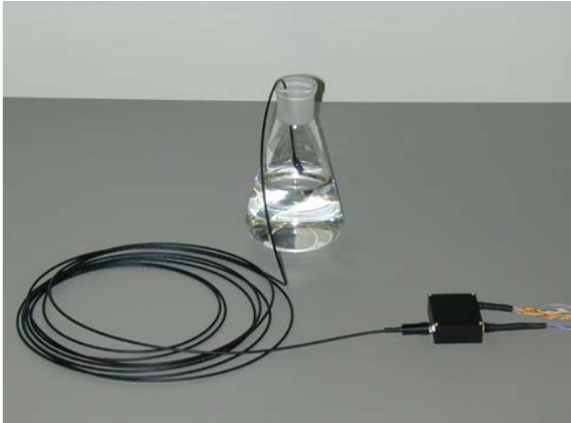
Joonis 14. Fotol on kujutatud anduri prototüüp. Näha on 5 meetri pikkune optiline kiud, mille otsas on hapnikutundlik element ja must karbike, milles paikneb elektro-optiline osa. Hapnikutundlik element on asetatud mõõtmiseks vette.
