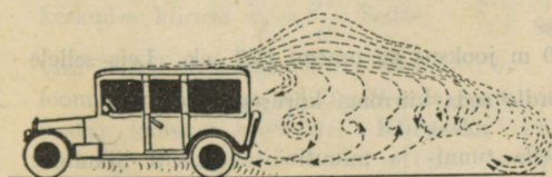
83. joon. Õhukeeriste tekkimine auto liikumisel.
