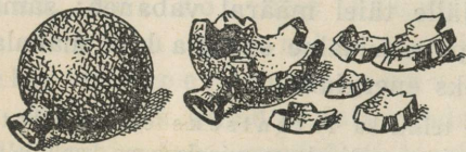
28. joon. Jääks muutudes paisub vesi tugevasti ja lõhub raudpomme.
