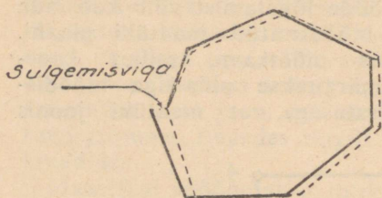
Joonis 53. Sulgemisviga ja selle kõrvaldamine
