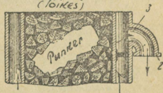
Joonis 170. Auto ZIS-21 gasogeeni gaasisuunav plaat.
