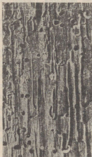
Joon. 59. Väikese toone- sepa ( Anobium domesticum ) kahjustus. Augud puidus on ümmargused, mis on ise- loomustavad toonesepade kahjustamisele.
