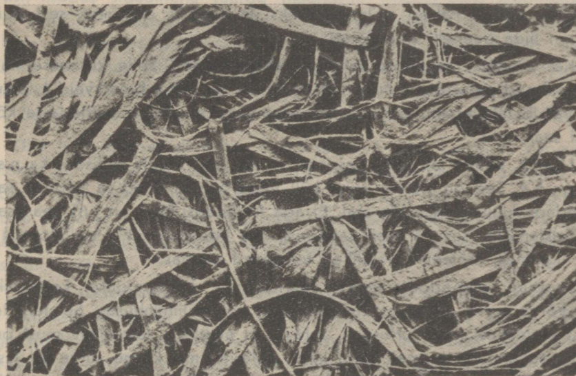
Joon. 119. TEP-plaadi korekiudne kiviköva pind loomulikus suuruses.
