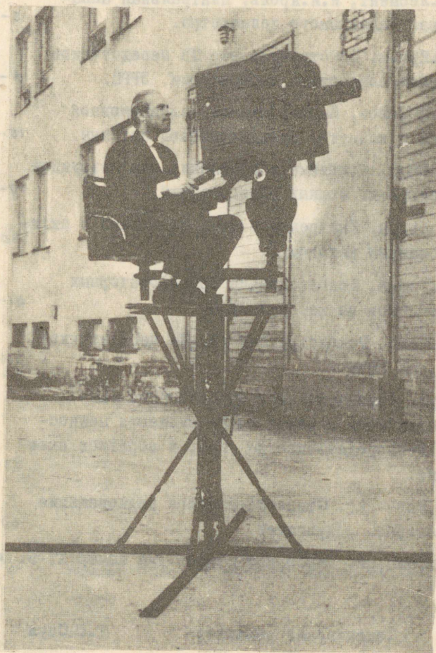
На Рис. 1 изображен штатив для камеры КТ-6 в собранном виде.
