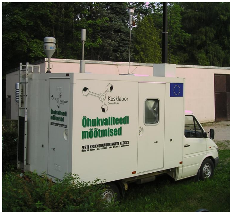
Joonis 11. Mobair, liikuv õhulabor (Marko Kaasiku foto)
