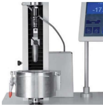
Joonis 8: Survejõu mõõtevahend
