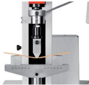
Joonis 9: Kolmepunktilise painutamise mõõtevahend
