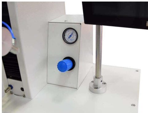
Joonis 2.1.: Suruõhu reguleerimine
