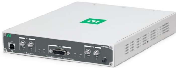
Joonis 1.3: USRP X300 SDR
