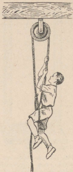
Joon. 119. Üle liikumatu plokki on pandud nõör, mille ühes otsas on silmus, kuhu on asetatud võimleja jalg, teist otsa tõmbab võimleja, tõstes iseennast.
