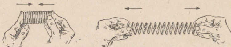
Joon. 27. Terasvedru surutakse kokku ja venitatakse välja.
