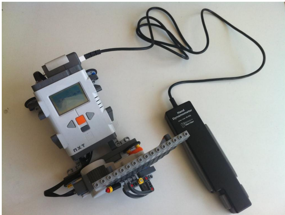
Joonis 11. Seieriga dünamomeetrit imiteeriv robot.
