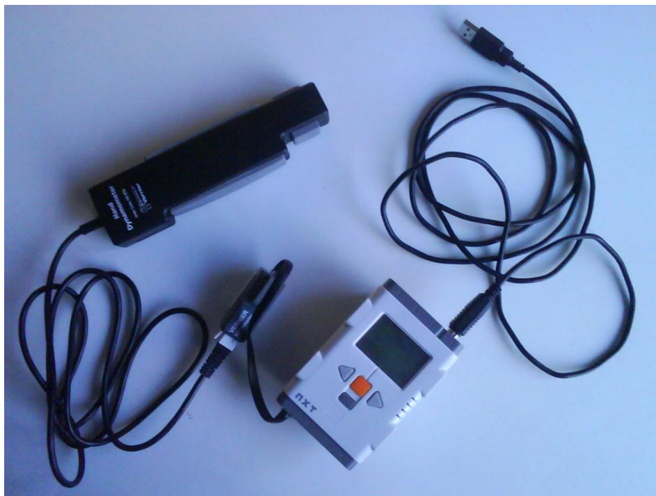
Joonis 7. Vernier käsidünamomeeter ühendatud NXT juhtploki külge
