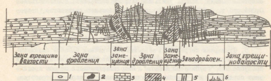
Рис. 3. Зональность глубинного карста в промышленном пласте горючих сланцев
