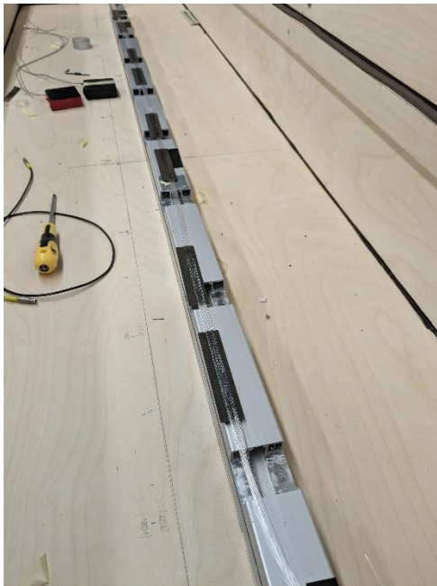
Joonis 3. Valguskindlas kastis olev katsestend, mille peale on asetatud stsintillatsioonkiu riba.
