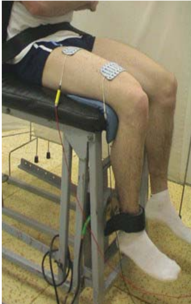
Joonis 1. Dünamomeetriline seade reie nelipealihase kontraktiilsete omaduste määramiseks ning vaatlusaluse asend testimisel.
