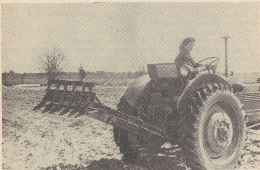
Рис. 27. Толкатель камней к трактору МТЗ-2 («Белорусь») в Вихула-ской машинно-тракторной станции (Раквереский район).
