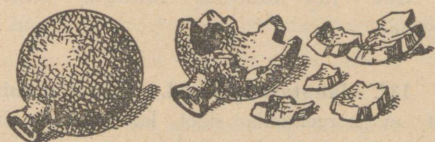
144. joon. Jääks muutudes paisub vesi tugevasti ja lõhub raudpomm.
