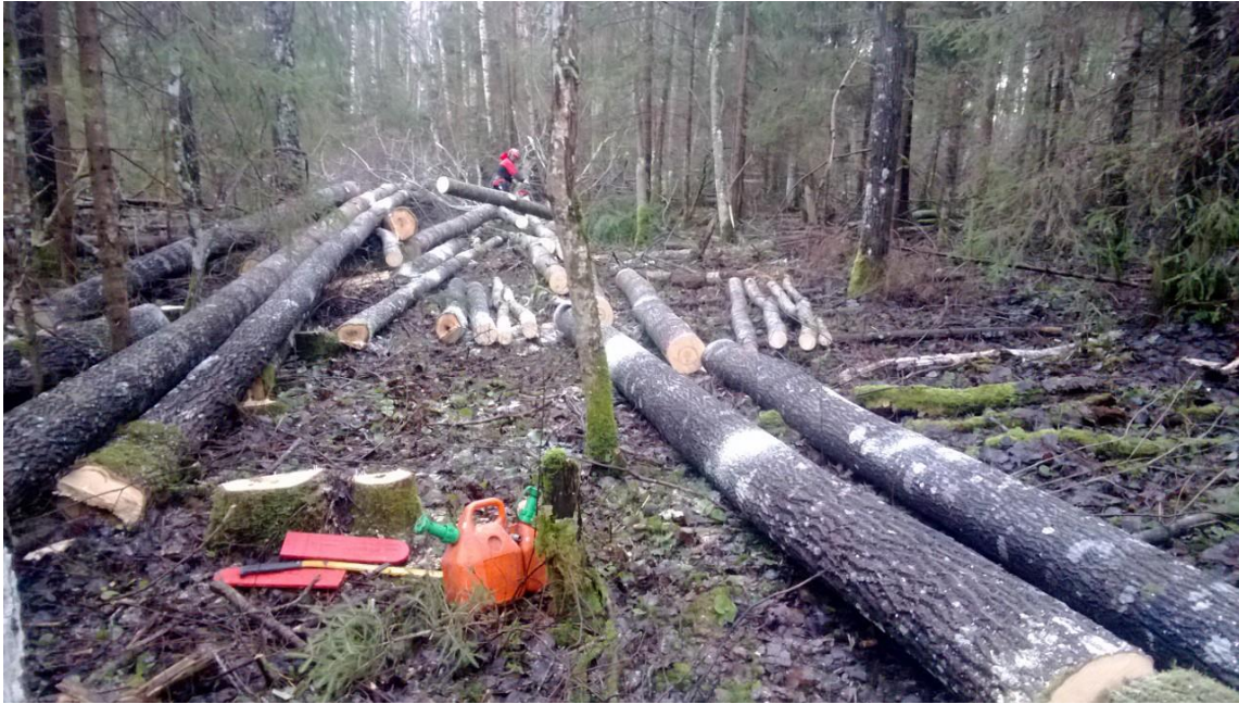
Foto 12 Esimeste majapalkide järkamine ja laasimine omanike metsas. (31.12.13)
