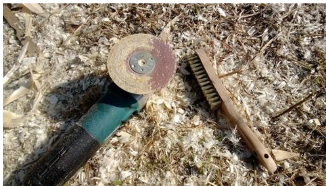
Joonis 13 Lihvketta puhastamine traatharjaga (Autori foto)
