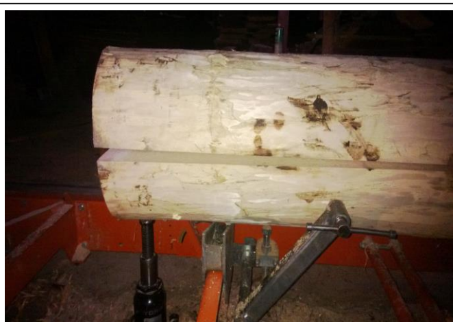
Joonis 10 Vabanenud sisepinged pärast haavast aluspalgi lõikust. (Autori foto)
