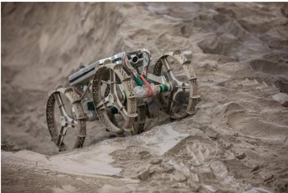
Joonis 2.2: Astroboticu CubeRoveri testimine regoliidi simulandis [14]
