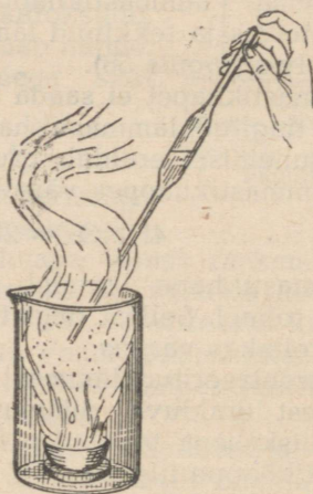
Joonis 58. Tärpentini süttimine lämmastikhappes.
