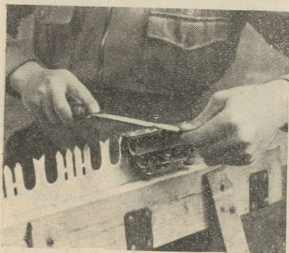
Joon. 88. Segahammastusega kahemehesae hõövelhammade allaviilimine.
