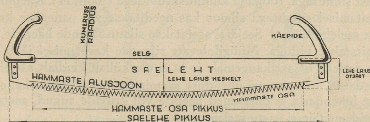
Joon. 12. Sae osade ja mõõtude nimetused.
