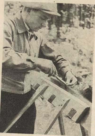
Joon. 51. Hambavahede allaviilimine mõõkviiliga.
