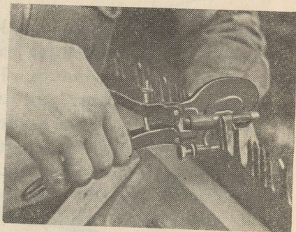
Joon. 62. Saehammaste jagamine suurte jaotangidega.
