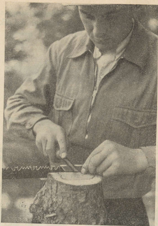
Joon. 87. Segahammastusega ühemehesae hõövelhammade allaviilimine.
