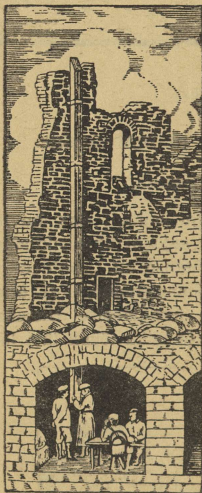
Joonis 107. Periskoop, mida tarvitasid sakslased sõjas 1914.—1918. a.
