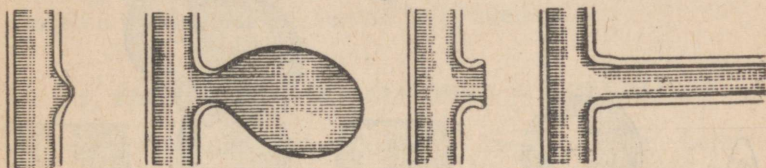
Joon. 11. Kolmiku ehk T-toru valmistamine.
