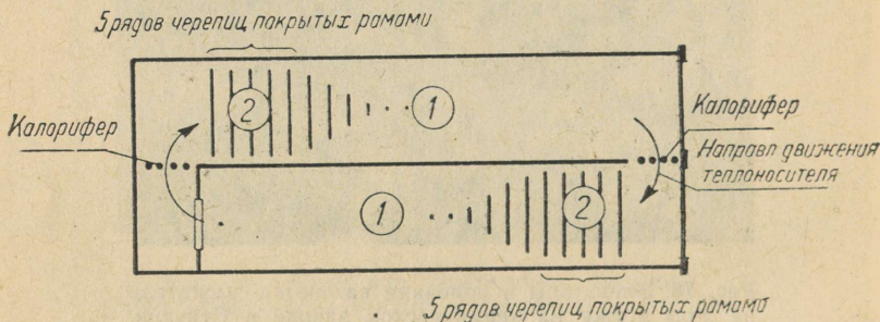
Рис. 77. Зона парных камер сушилки, в которых сырец черепицы, во избежание его трескания при сушке, покрывается деревянными рамами.
